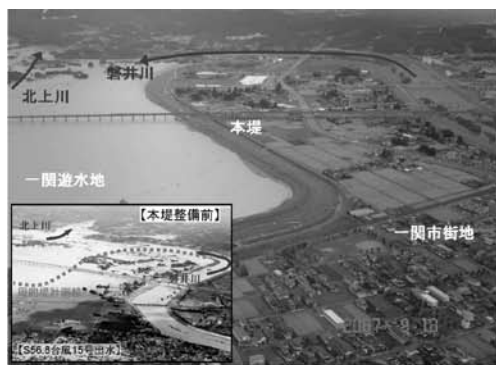
市街地を防御した一関遊水地本堤 (平成19年9月18日出水 岩手県一関市)
