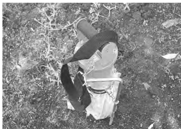
GPSを内蔵した土壤測定器
