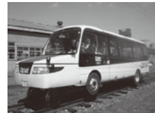
JR北海道が開発したDMV “Darwin” 写真提供：JR北海道
