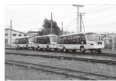
JR北海道が開発したDMV “Darwin” 写真提供：JR北海道
