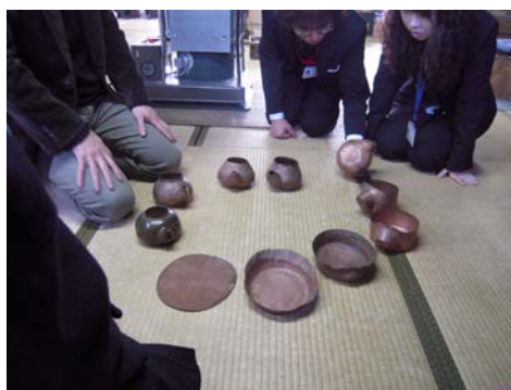
製造過程の説明（1枚の板から継ぎ目なしに作り込んでいく）
