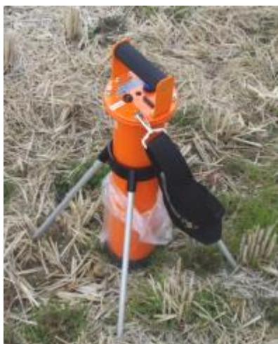
写真 3-1 (左) GPS 内蔵土壤汚染スクリーニングシステム AT6101DR : 検出器
