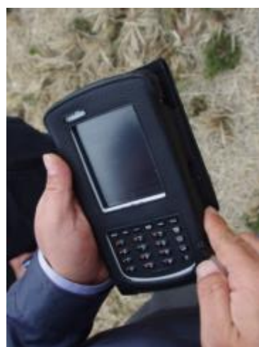
写真 3-1 (左) GPS 内蔵土壤汚染スクリーニングシステム AT6101DR : 検出器
